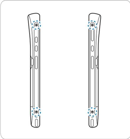
5 Screw를 제거한 위치에 1~3에서 결합한 Strap을 동봉된 4개의 Screw를 사용하여 그림과 같이 결합하세요.
